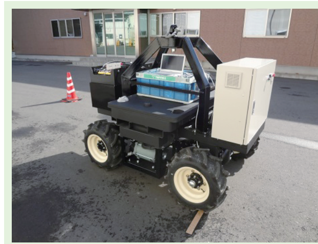
第6-14図 放水砲ロボットの走行機構
