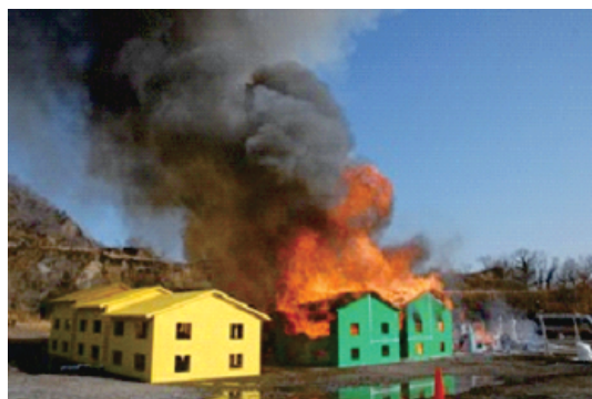
模型木造住宅(床面積3.6m×3.6m)を19棟用いた市街地火災の模擬実験
